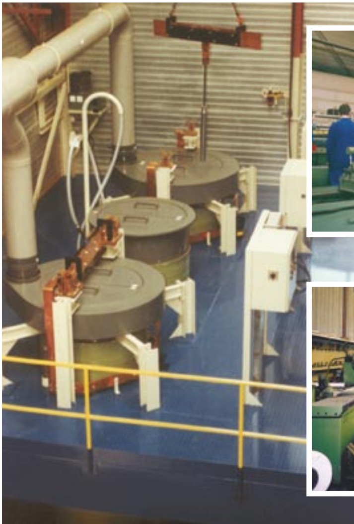
Eigen chrominstallatie waar zuigerstangen, assen en bussen in eigen beheer worden verchromd
